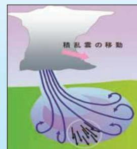
積乱雲から吹き下ろす気流が地表に衝突して周囲に吹き出す激しい気流です。被害域は面的に広がります。強雨やひょうを伴うことが多いです。
