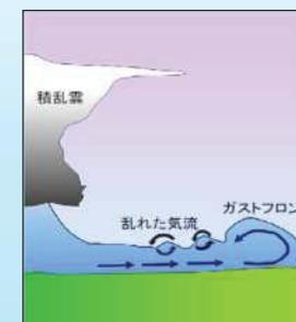
積乱雲の下に溜まった冷気が周囲に流れ出し、周囲の空気との間に作る境界です。水平の広がりは竜巻やダウンバーストより大きく、数十km以上に達することもあります。
